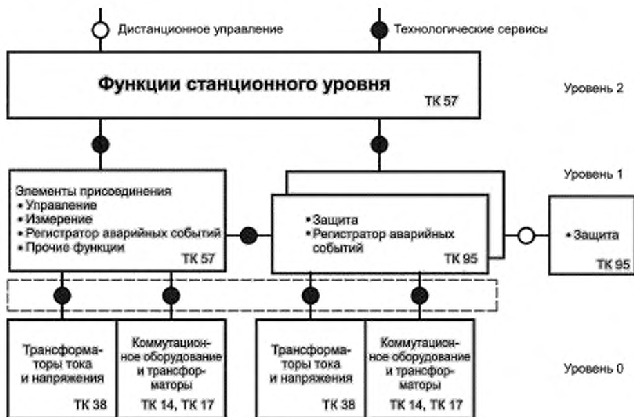
Рисунок 1 — Логические интерфейсы СА-системы
