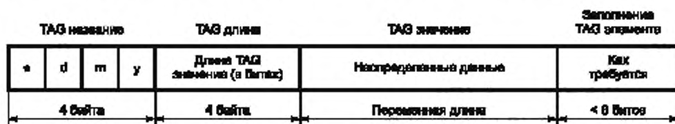
Рисунок 8 — Фиктивное заполнение TAG элемента
