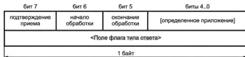
Рисунок Е.5 — Структура поля флага типа ответа
