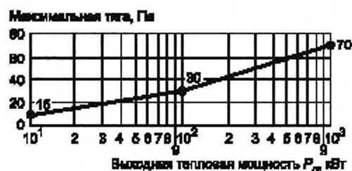
Рисунок 3 — Требования к тяге для котлов, работающих на естественной тяге при отрицательном давлении в топке
