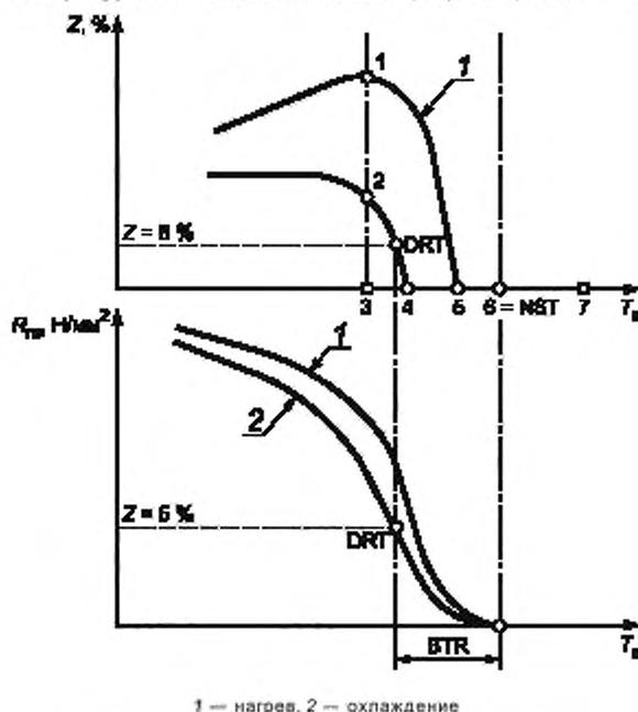
Рисунок 2 — Графики, построенные по результатам испытания
