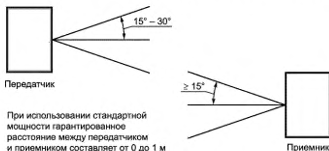
Рисунок А.1 — Угол зрения и расстояние для физического уровня IrDA
