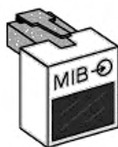
Рисунок D.4 — Инфракрасный адаптер для порта ПК, соответствующего ИСО/ИИЭР 11073-30200
