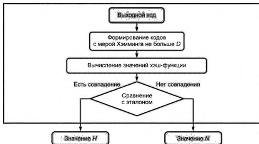
Рисунок 5 — Блок-схема работы мягкого индикатора, перебирающего пространство близких значений выходного кода
