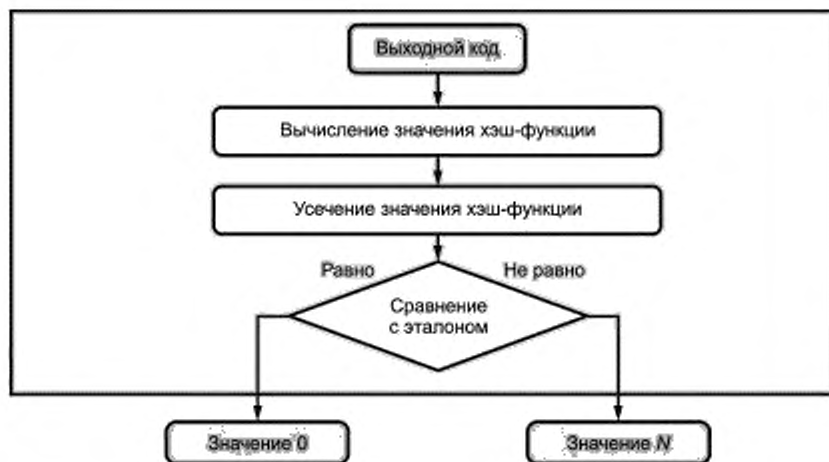
Рисунок 4 — Блок-схема работы жесткого индикатора
