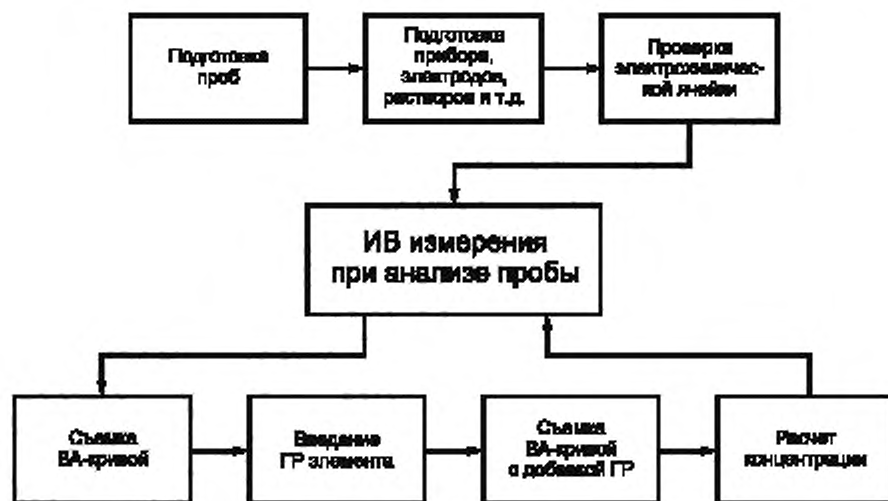
Рисунок 1 — Основные этапы анализа проб методом ИВ
