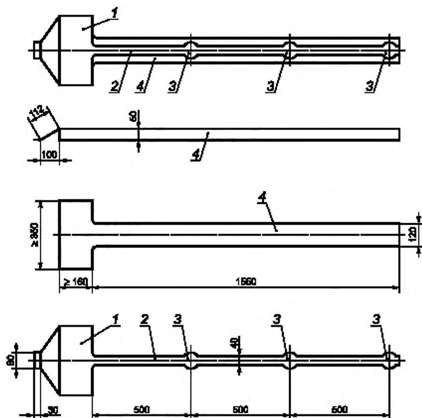
1 — пластина связи, выступающая на 10 мм со всех сторон ТС, минимального размера 160 × 350 мм, конусообразная секция для соединения с горизонтальной пластиной связи; 2 — соединительная лента (шириной 40 мм) для поддержки ремней безопасности; 3 — разрядные площадки кондуктивно соединенные с лентой связи диаметром 80 мм; 4 — ТС и изоляционный жгут проводов из непроводящего материала  $\epsilon_r < 2,5$ , высотой 50 мм (вспененный полипропилен или пенопласт)
