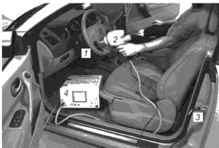
1 – ТС; 2 – испытательный генератор; 3 – основной блок испытательного генератора (внутри или снаружи автомобиля); 4 – соединение с заземлением испытательного генератора
