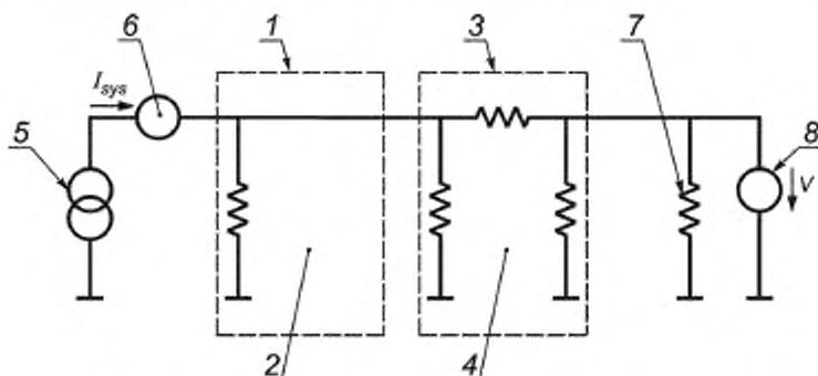
1 — датчик тока; 2 — пример внутренней схемы датчика тока; 3 — attenuator; 4 — внутренняя схема attenuator; 5 — источник постоянного тока; 6 — амперметр; 7 — нагрузка 50 Ом; 8 — цифровой вольтметр
