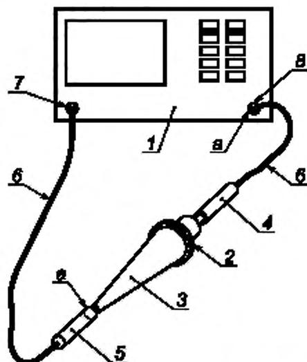
а — анализатор цепей должен калиброваться в этих точках; 1 — анализатор цепей; 2 — датчик тока; 3 — конусообразный адаптер 50 Ом; 4 — аттенюатор А; 5 — аттенюатор В; 6 — коаксиальный кабель; 7 — выходной соединитель анализатора цепей; 8 — входной соединитель анализатора цепей
