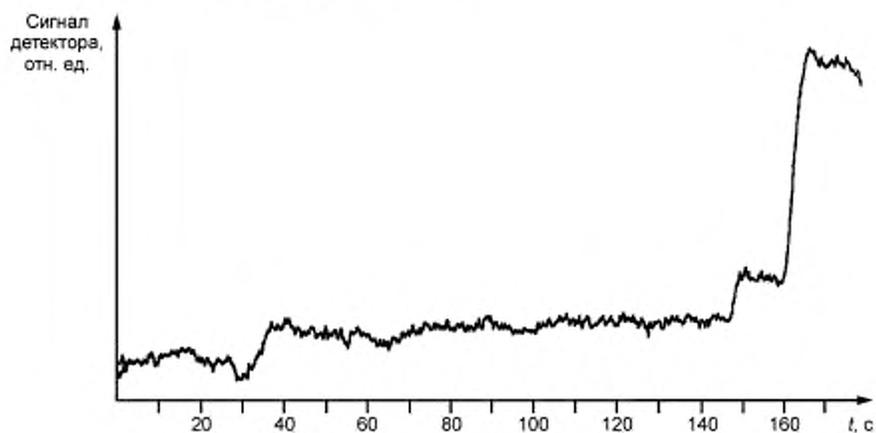
Рисунок Б.3 — Электрофореграмма сточной воды без отгонки
