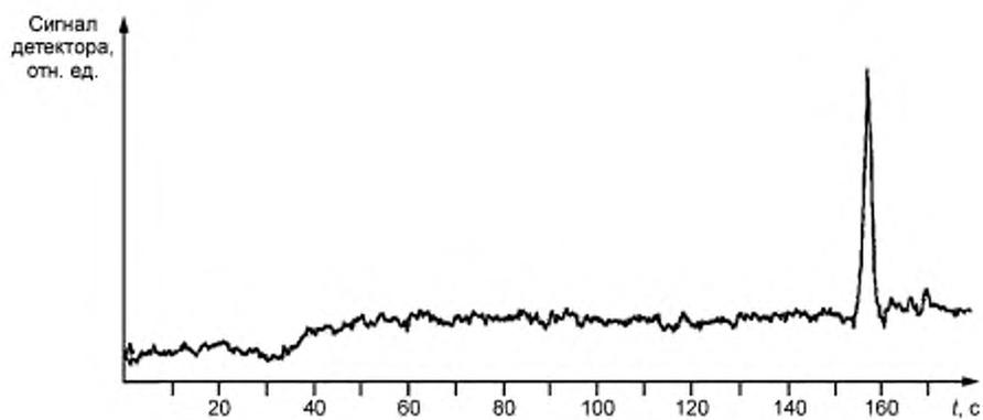
Рисунок Б.4 — Электрофореграмма сточной воды с отгонкой
