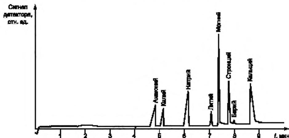
Рисунок Б.1 — Электрофореграмма градуировочного раствора № 3
