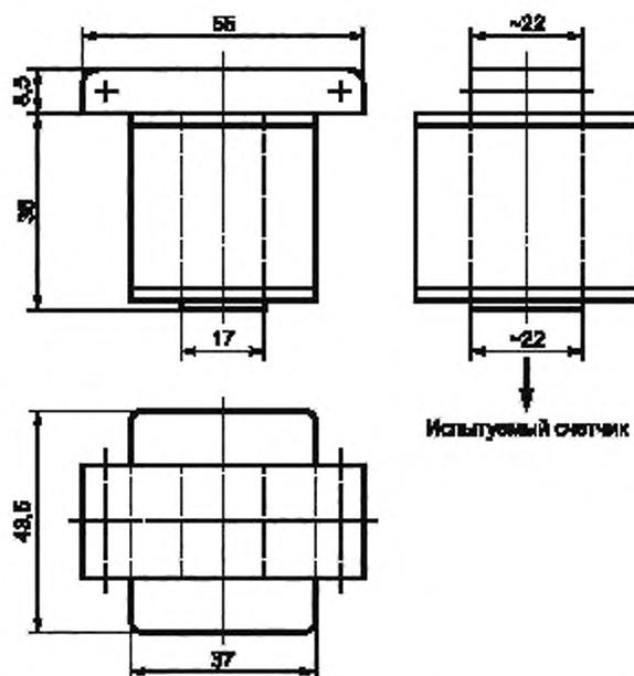
Примеры обмотки: 500 витков проволоки диаметром 0,6 мм, сечением 0,28 мм<sup>2</sup> или 1000 витков проволоки диаметром 0,4 мм, сечением 0,126 мм<sup>2</sup>.
