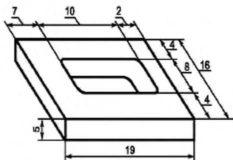
Примечание — Внутренние углы могут быть закруглены. Допуски на размеры  $\pm 0,1$  мм
