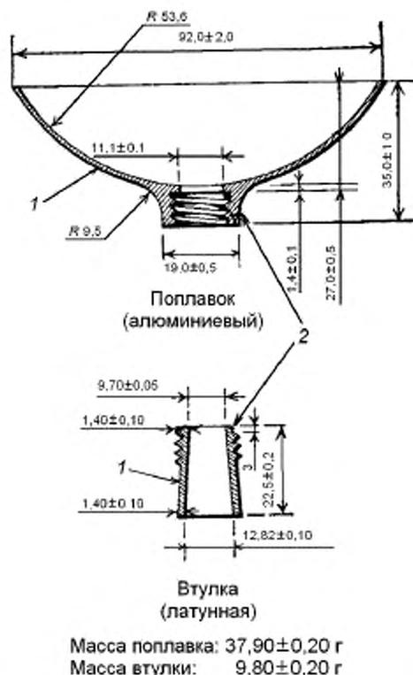
1 – скошен для обеспечения нагрузки; 2 – стандартная резьба 5/8 дюйма
