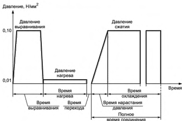
Рисунок 2 — Стадии процесса сварки нагретым инструментом астык
