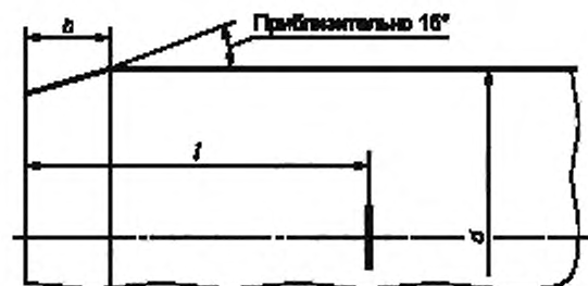
Рисунок 5 — Снятие фаски с конца трубы
