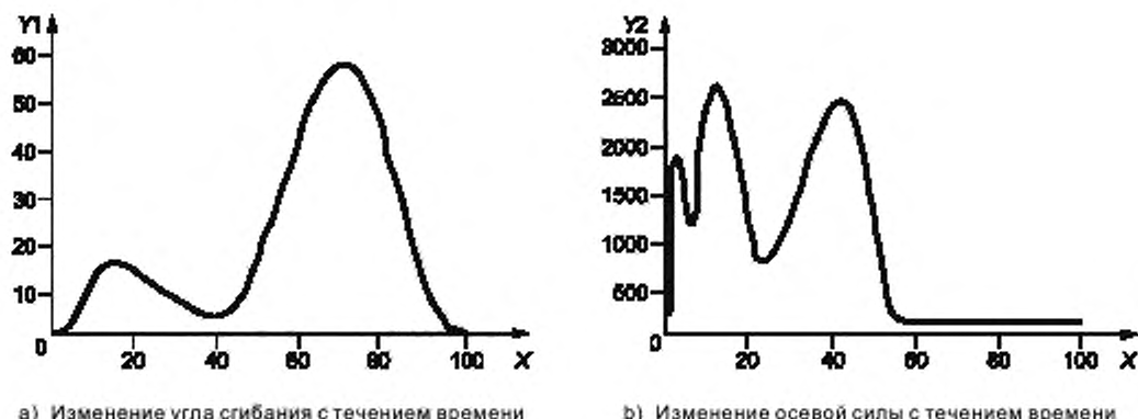
Рисунок 3 — Изменение угла сгибания и осевой силы с течением времени
