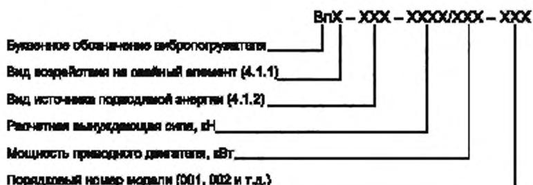
Пример условного обозначения безударного гидравлического вибропогрузателя с мощностью приводного двигателя 160 кВт, расчетной вынуждающей силой 1250 кН второй модели:
