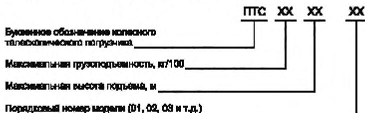
Пример условного обозначения погрузчика с телескопической стрелой с грузоподъемностью 2,5 т, высотой подъема 7 м, третьей модели:
