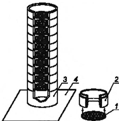
1 — съемное сито с металлической сеткой (диаметр 98,5 мм); 2 — стакан съемного сита (диаметр 100,0 мм, высота 50,0 мм).
