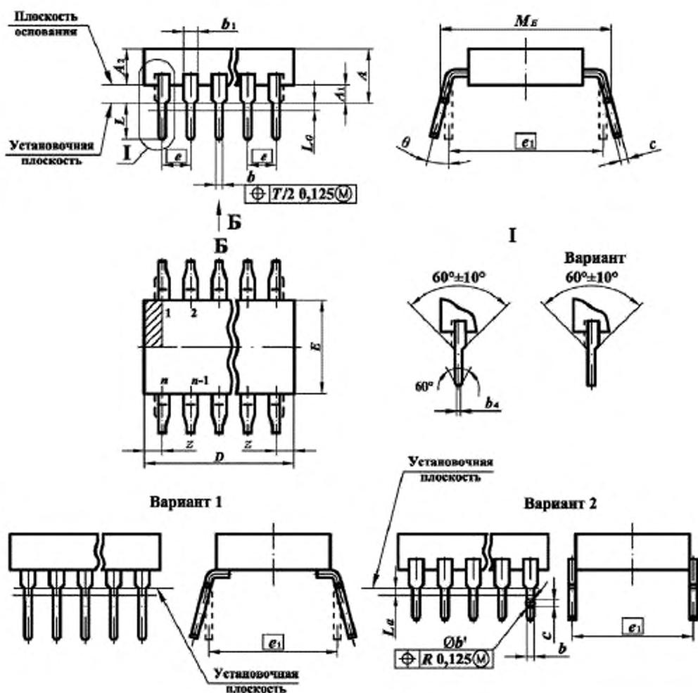
Рисунок 6 – Микросхемы в корпусах подтипа 21
