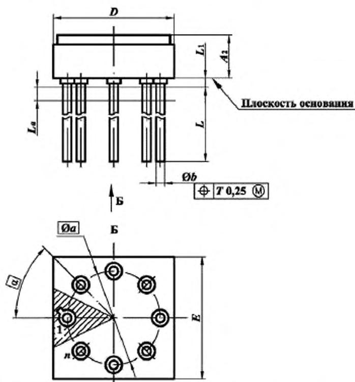
Рисунок 10 – Микросхемы в корпусах подтипа 33
