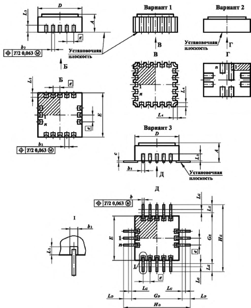
Рисунок 16 – Микросхемы в корпусах подтипа 51
