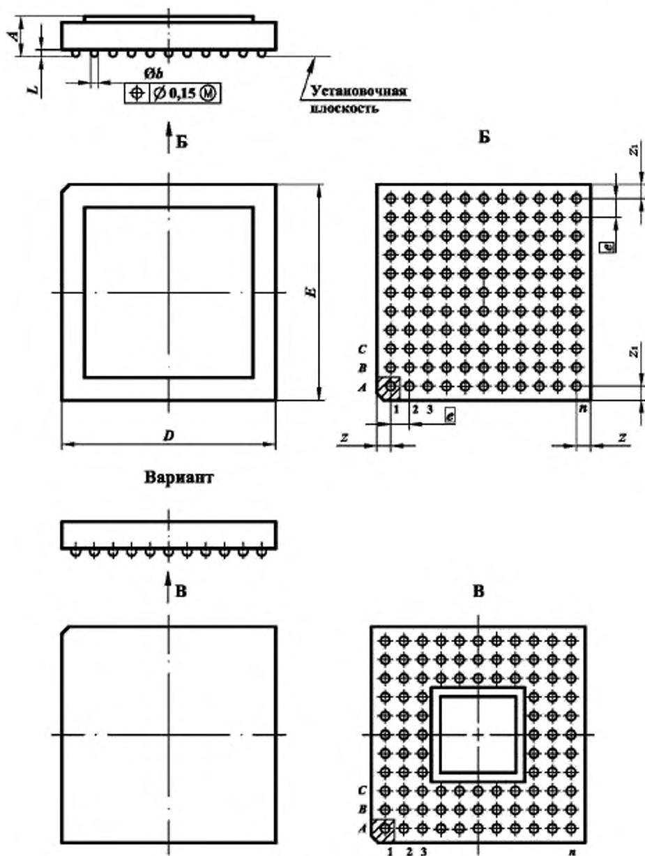
Рисунок 21 – Микросхемы в корпусах подтипа 81
