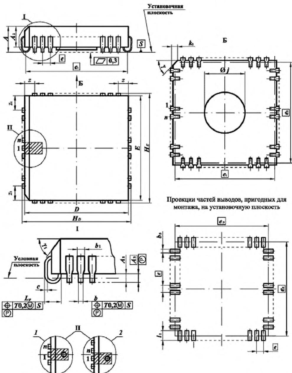
Проекция частей выводов, пригодных для монтажа, на установочную плоскость
