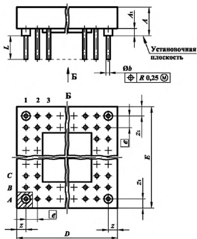
Примечание – контроль позиционных допусков осей выводов проводят на  $L = L_{\text{н}}$ .
