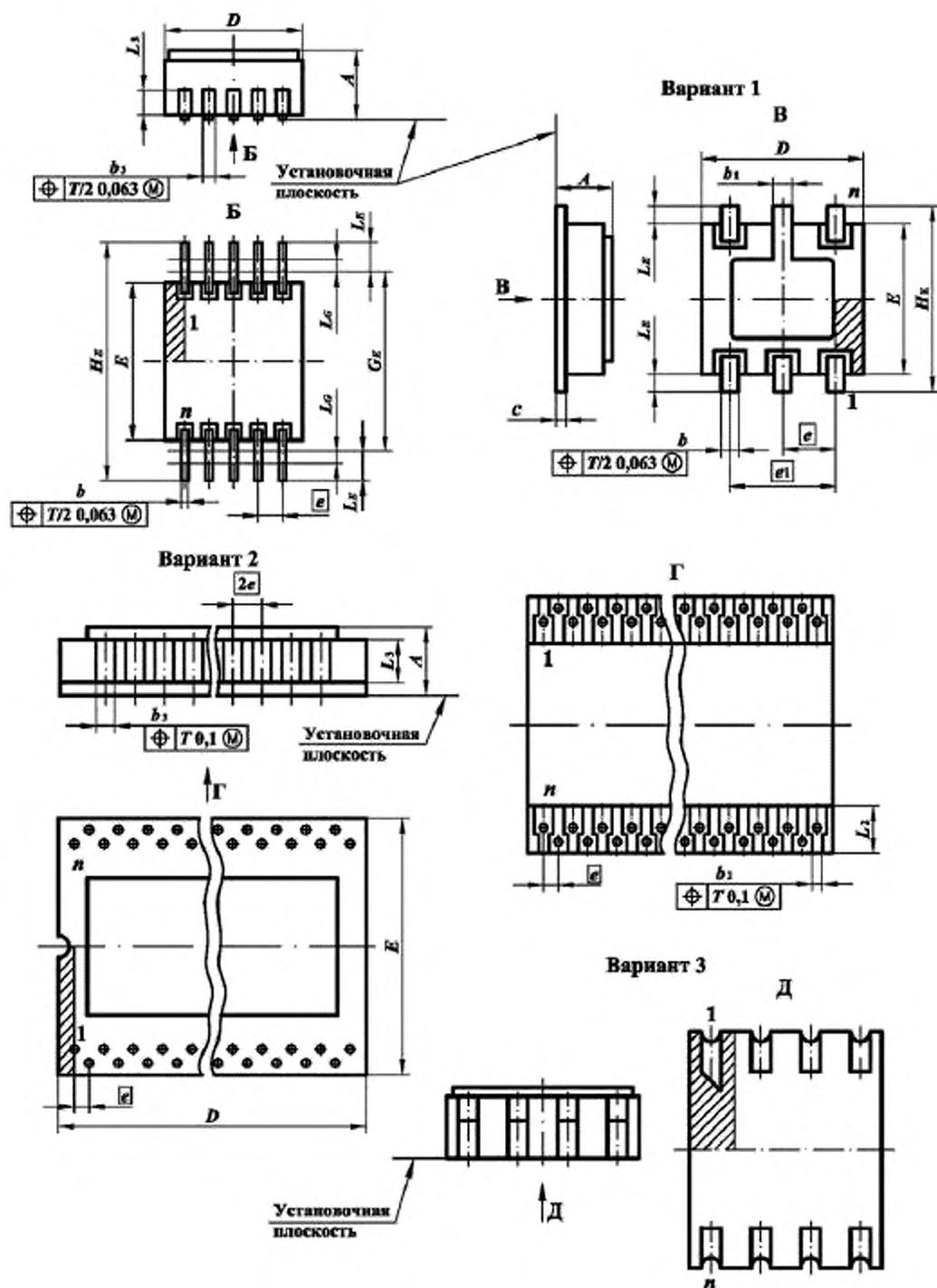
Рисунок 17 – Микросхемы в корпусах подтипа 52
