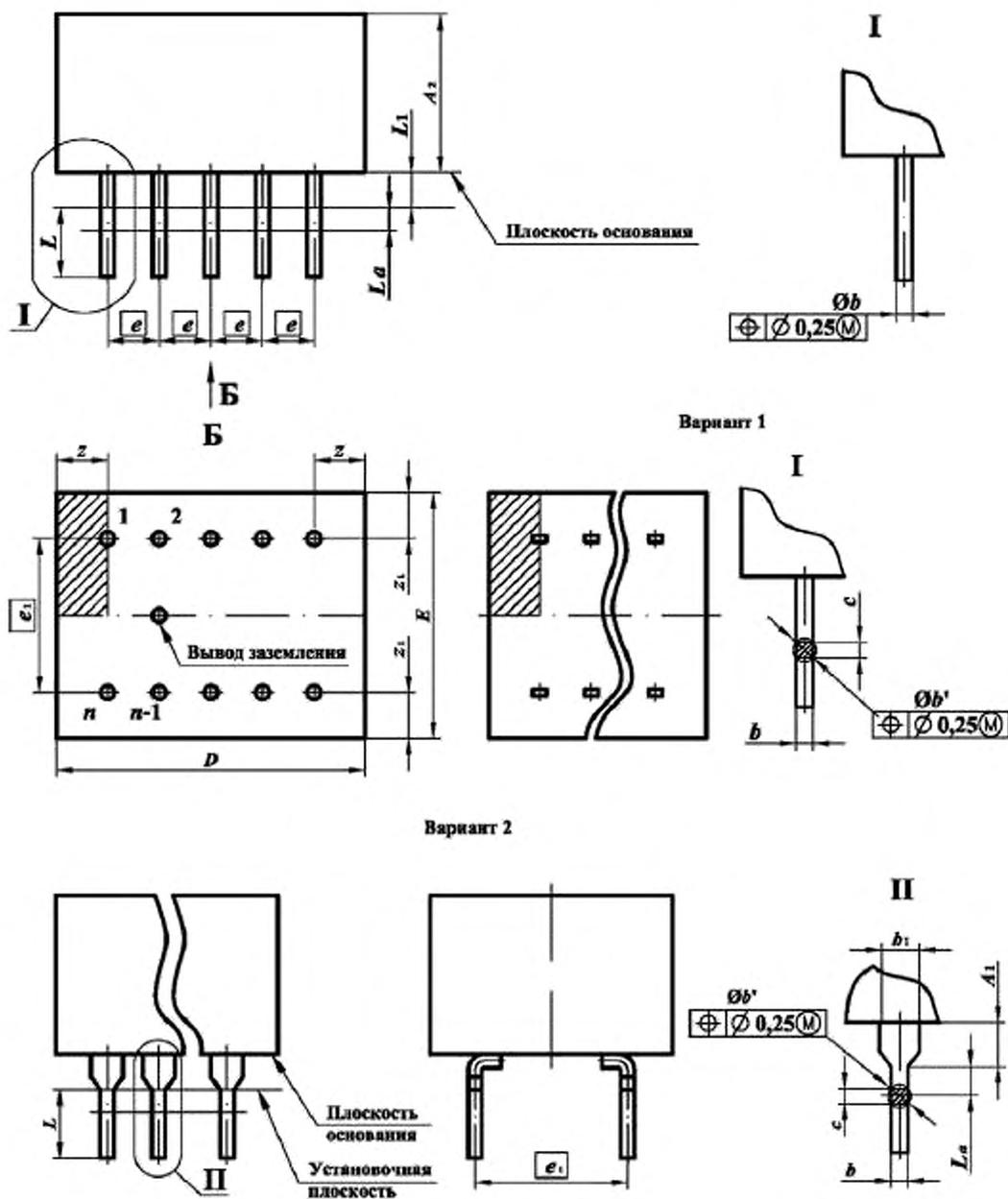
Примечание – Вывод заземления должен располагаться в узле координатной сетки с шагом 2,5 мм.
