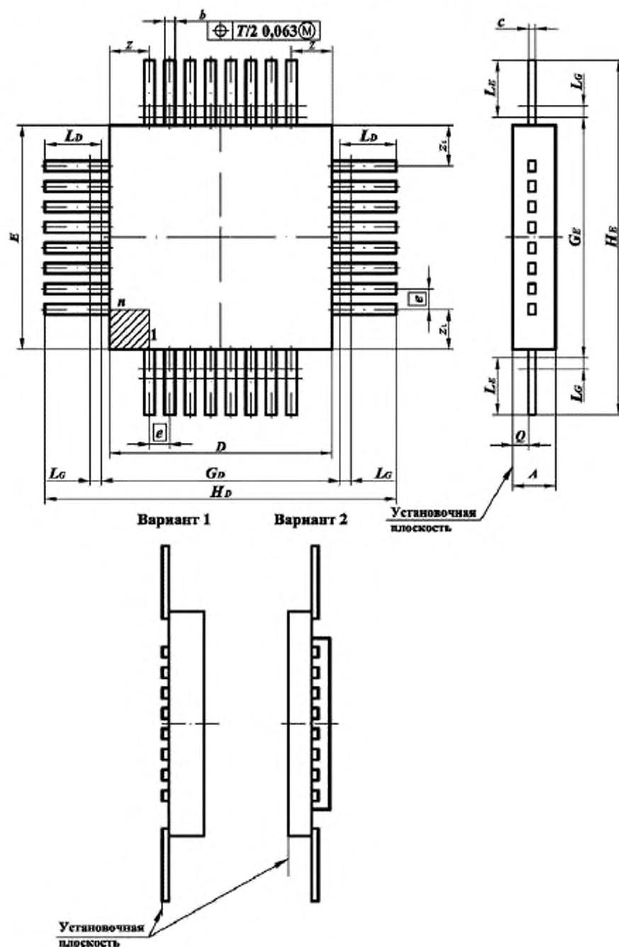
Рисунок 12 – Микросхемы в корпусах подтипа 42
