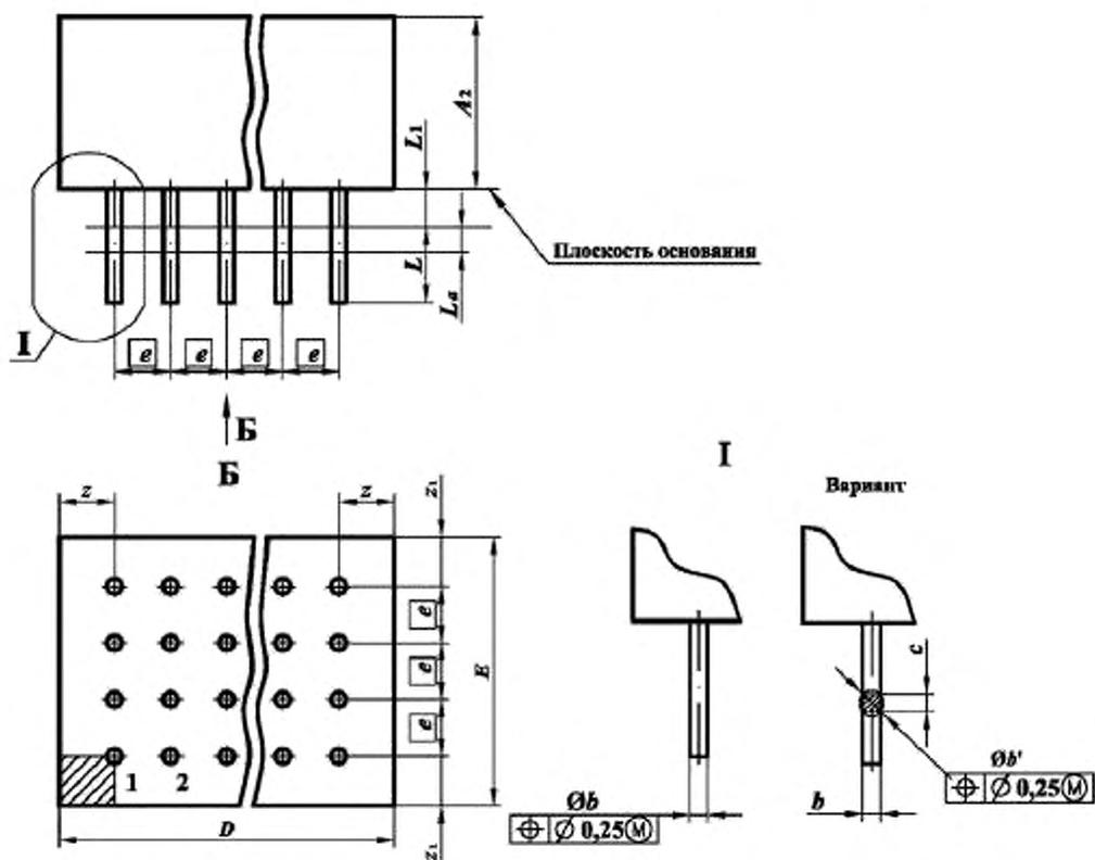
Рисунок 3 – Микросхемы в корпусах подтипа 13
