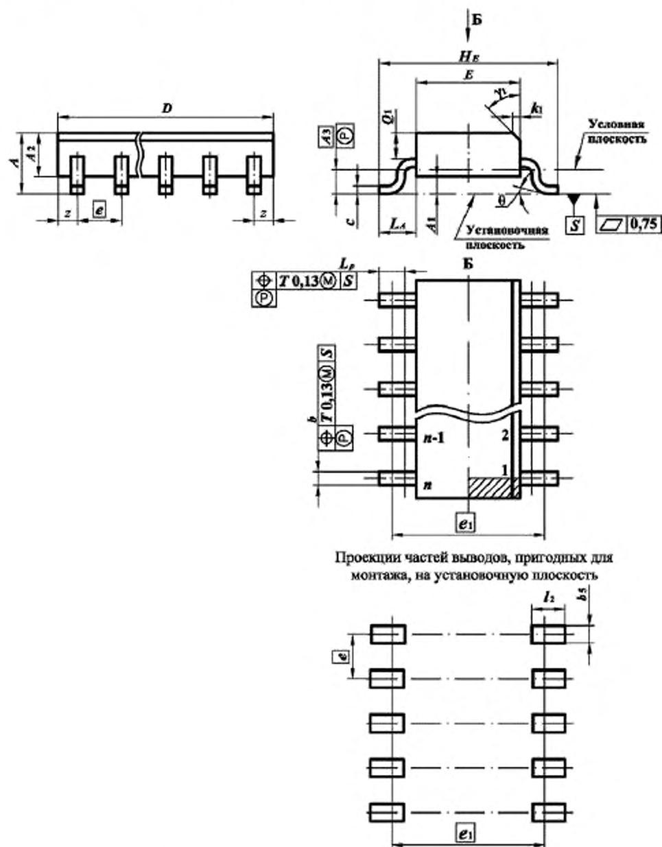
Рисунок 13 – Микросхемы в корпусах подтипа 43
