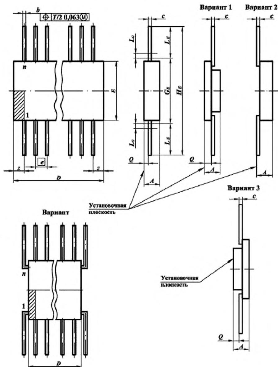
Рисунок 11 – Микросхемы в корпусах подтипа 41
