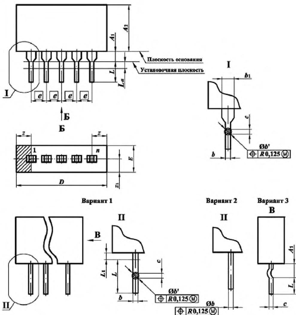
Рисунок 1 – Микросхемы в корпусах подтипа 11
