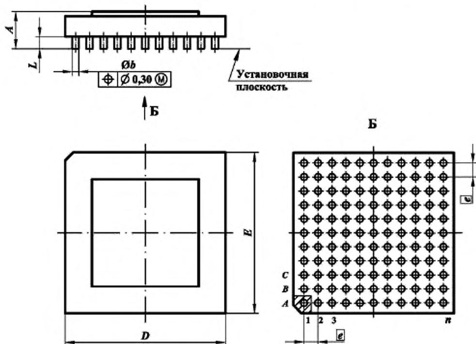
Рисунок 22 – Микросхемы в корпусах подтипа 82
