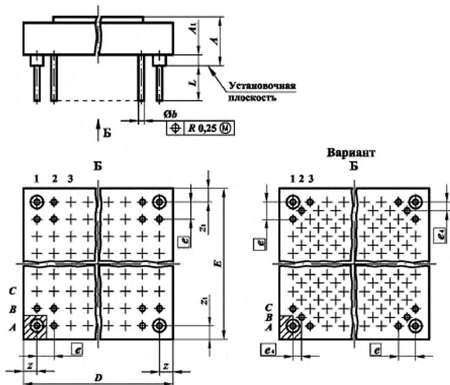
Примечание - Контроль позиционных допусков осей выводов проводят на  $L = L_0$ .
