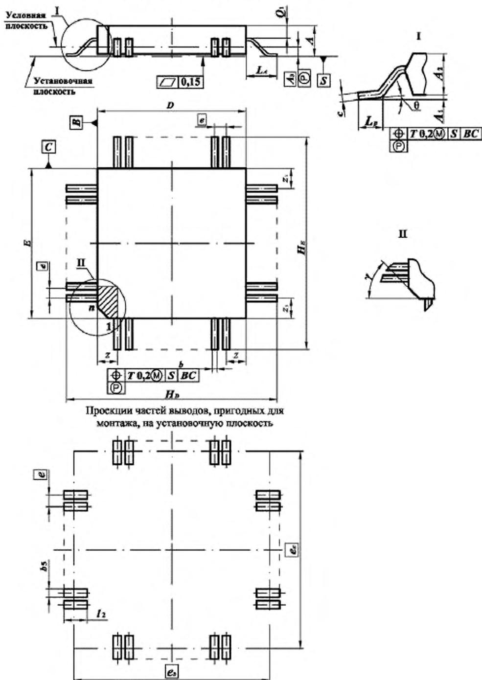
Рисунок 14 – Микросхемы в корпусах подтипа 44
