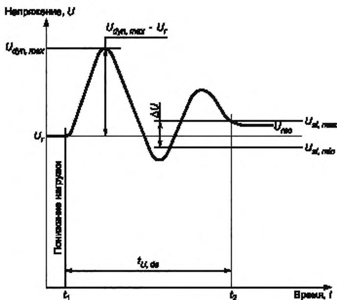
Рисунок А.2 — Характеристика переходного напряжения (понижение нагрузки)
