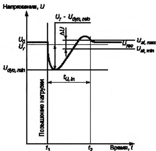
Рисунок А.1 — Характеристика переходного напряжения (повышение нагрузки)
