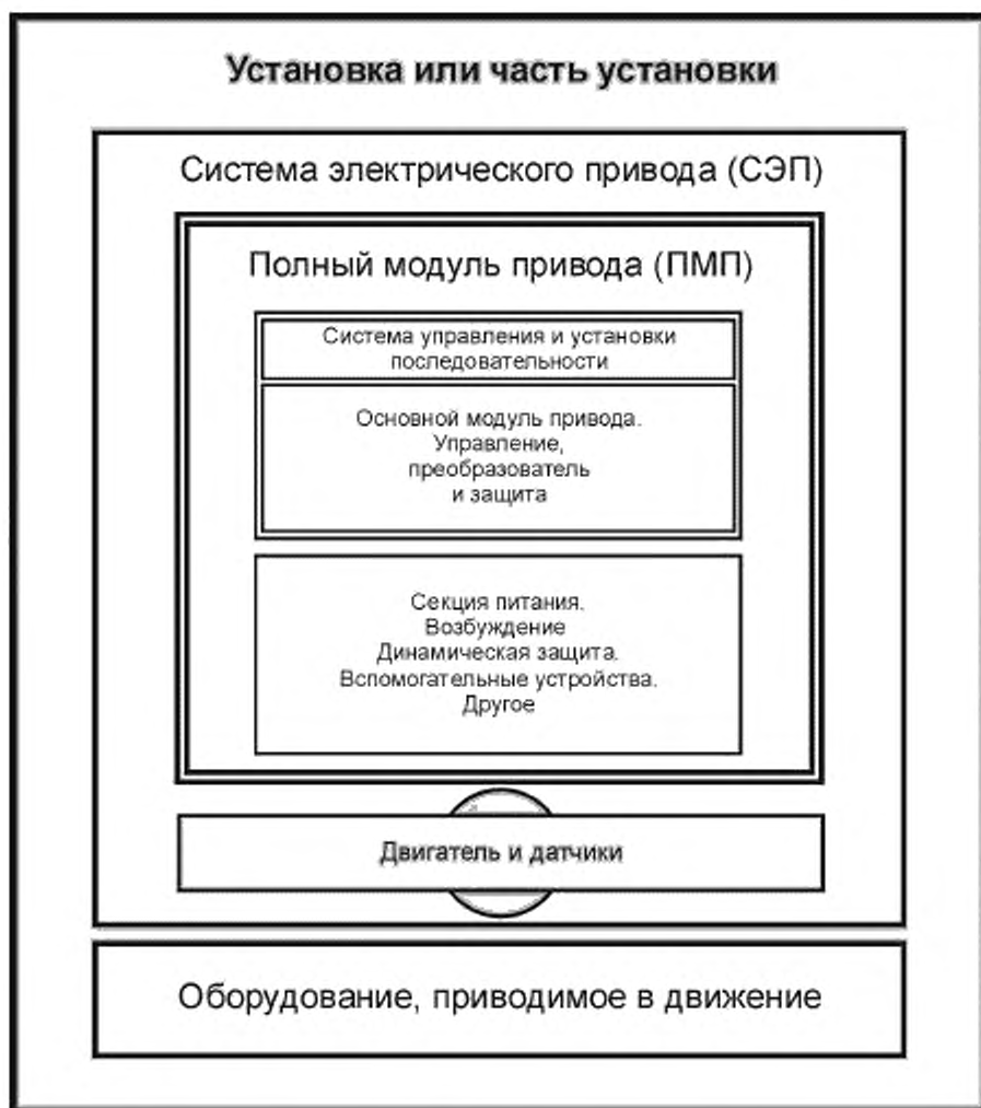
Рисунок 1 — Определения, относящиеся к установке и ее составу
