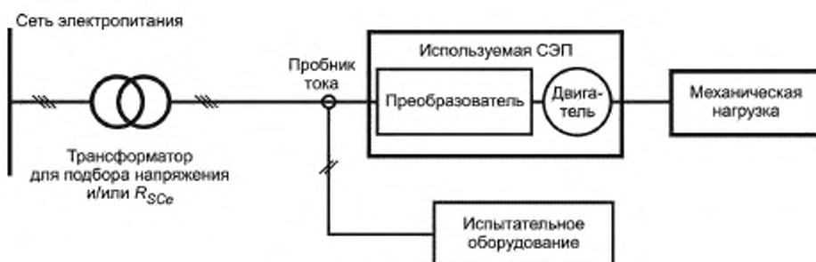
Рисунок В.6 — Испытательная установка с механической нагрузкой
