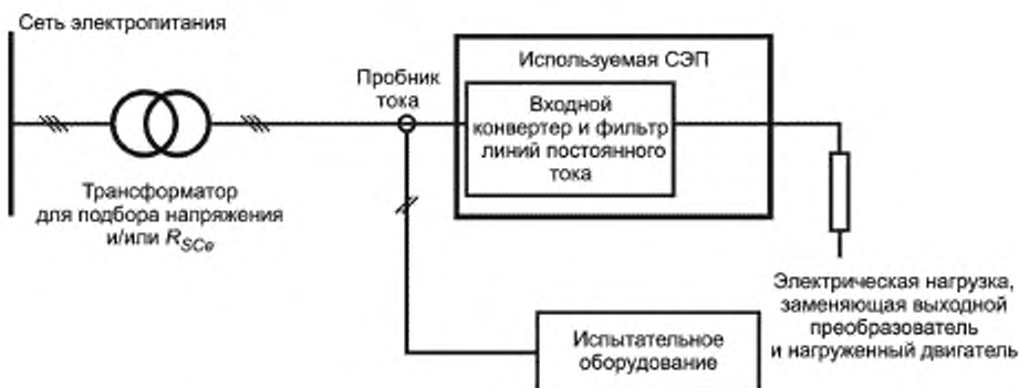
Рисунок В.8 — Испытательная установка с резистивной нагрузкой
