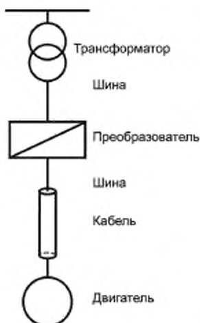
Рисунок Е.3 — Пример электрического привода
