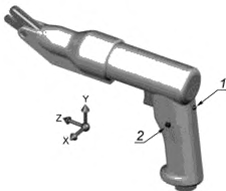
1 — предпочтительная точка измерений; 2 — дополнительная точка измерений
