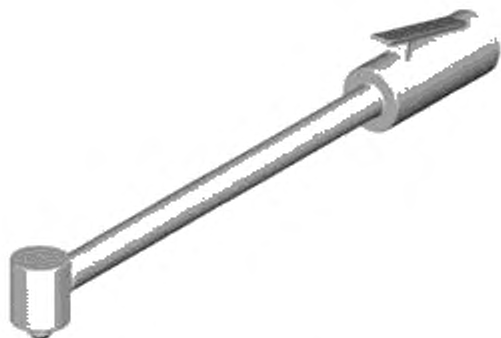
Рисунок 5 — Угловой зачистной молоток (камнетес)
