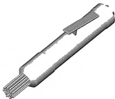
Рисунок 2 — Прямой пучковый зачистной молоток
