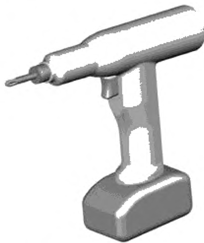
Рисунок 10 — Шуруповерт с центрированной рукояткой пистолетного типа
