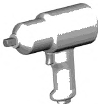
Рисунок 1 — Ударный/импульсный гайковерт с рукояткой листового типа
