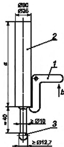
*a* — длина бойка, при которой общая масса бойка с индентором составляет  $(500 \pm 5)$  г; *b* — направление движения при освобождении бойка; 1 — спусковой механизм; 2 — боек; 3 — индентор
