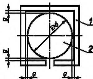
$d$  — диаметр бойка (от 25 до 30 мм);  $g$  — зазор (от 0,5 до 1 мм); 1 — направляющая штанга (например, квадратная трубка с прорезью); 2 — боек
