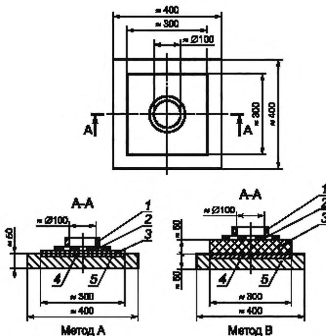
1 — балластное кольцо; 2 — образец; 3 — подложка (алюминиевая пластина для метода А или плита из пенополистирола для метода В); 4 — стальная пластина; 5 — бетонная плита
