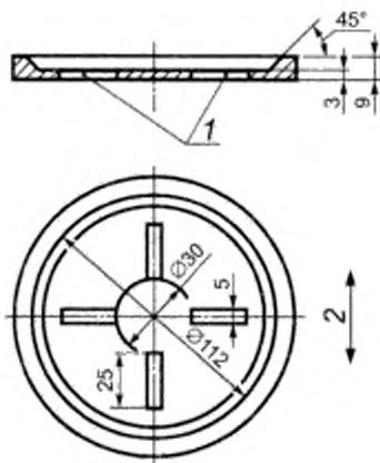
1 – радиус закругления в сек. граней диска  $\approx 0,5$  мм; 2 – продольное направление образца
