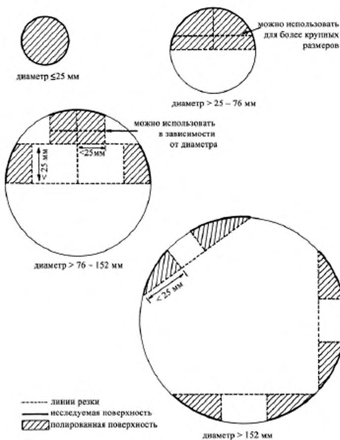
Рисунок 1 – Типичные схемы отбора образцов для круглых прутков различного размера.
