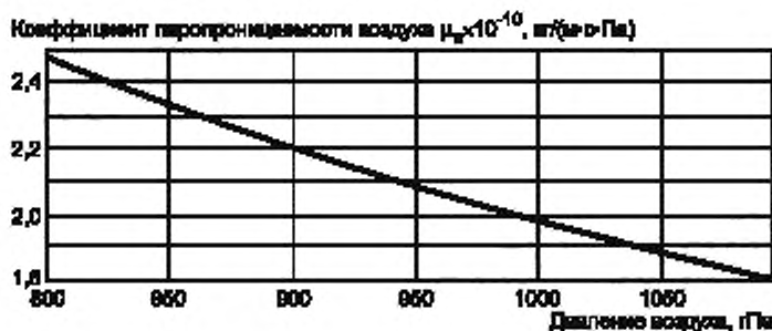
Рисунок А.1 — График зависимости коэффициента паропроницаемости воздуха от давления при температуре 23 °С
