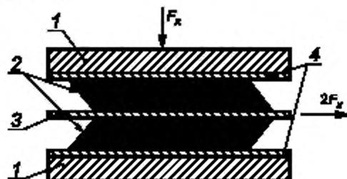
1 — плиты пресса, 2 — образец для испытания, 3 — подвижная плита; 4 — выравнивающие плиты с пазами предназначенными для предотвращения проскальзывания резиновой опорной части;
