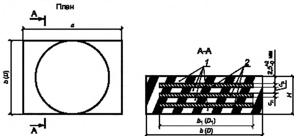
1 — резина, 2 — промежуточные стальные листы;  $a, b(D)$  — размеры опорной части в плане;  $a_1, b_1(D_1)$  — размеры в плане стальных листов;  $c_n$  — толщины стальных листов,  $c_p$  — толщины промежуточных слоев резины;  $H$  — высота опорной части
