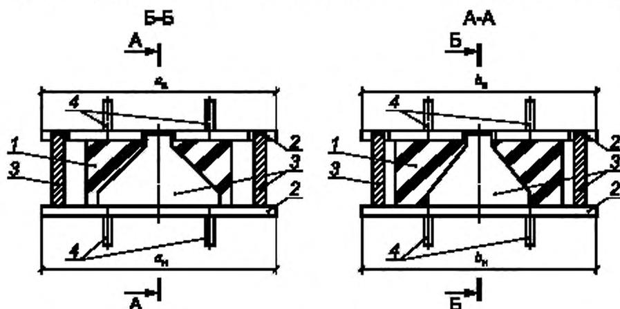
1 — резиновая опорная часть; 2 — закладные детали в пролетном строении и опоре; 3 — ограничители перемещения (упоры); 4 — анкера;  $a_в$ ,  $a_н$ ,  $b_в$ ,  $b_н$  — размеры верхней и нижней закладных деталей в плане;  $H_с$  — высота опорной части с закладными деталями
