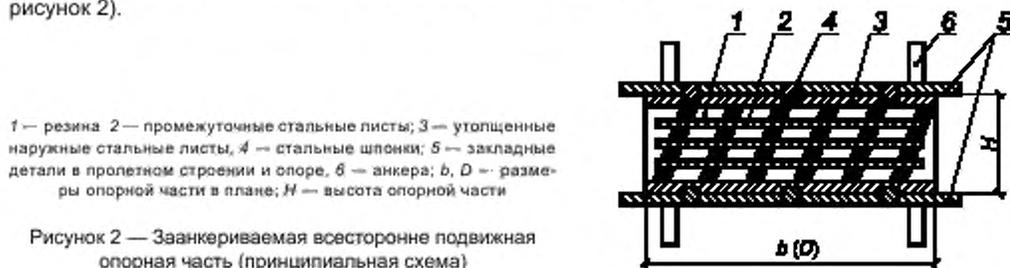
1 — резина, 2 — промежуточные стальные листы; 3 — утолщенные наружные стальные листы, 4 — стальные шпонки; 5 — закладные детали в пролетном строении и опоре, 6 — анкера;  $b, D$  — размеры опорной части в плане;  $H$  — высота опорной части
