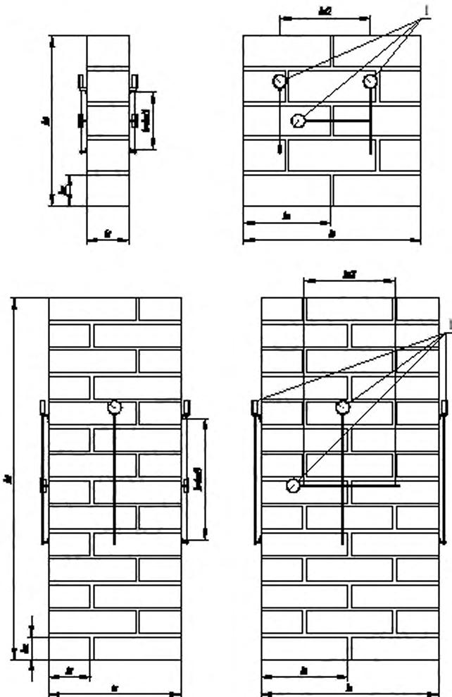
1 – приборы для измерения деформаций;  $b$  – база измерения деформаций;  $h_s$  – высота образца;  $h_u$  – высота элемента кладки;  $t_s$  – толщина образца;  $t_u$  – толщина элемента кладки;  $l_s$  – длина образца;  $l_u$  – длина элемента кладки
