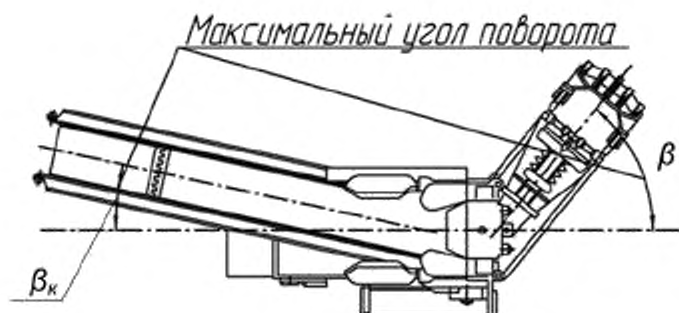
Рисунок 8 — Проверка машины на поперечную устойчивость
