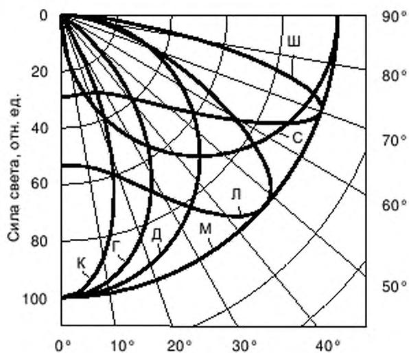
К – концентрированная; Г – глубокая; Д – косинусная; Л – полуширокая; Ш – широкая; М – равномерная; С – синусная
