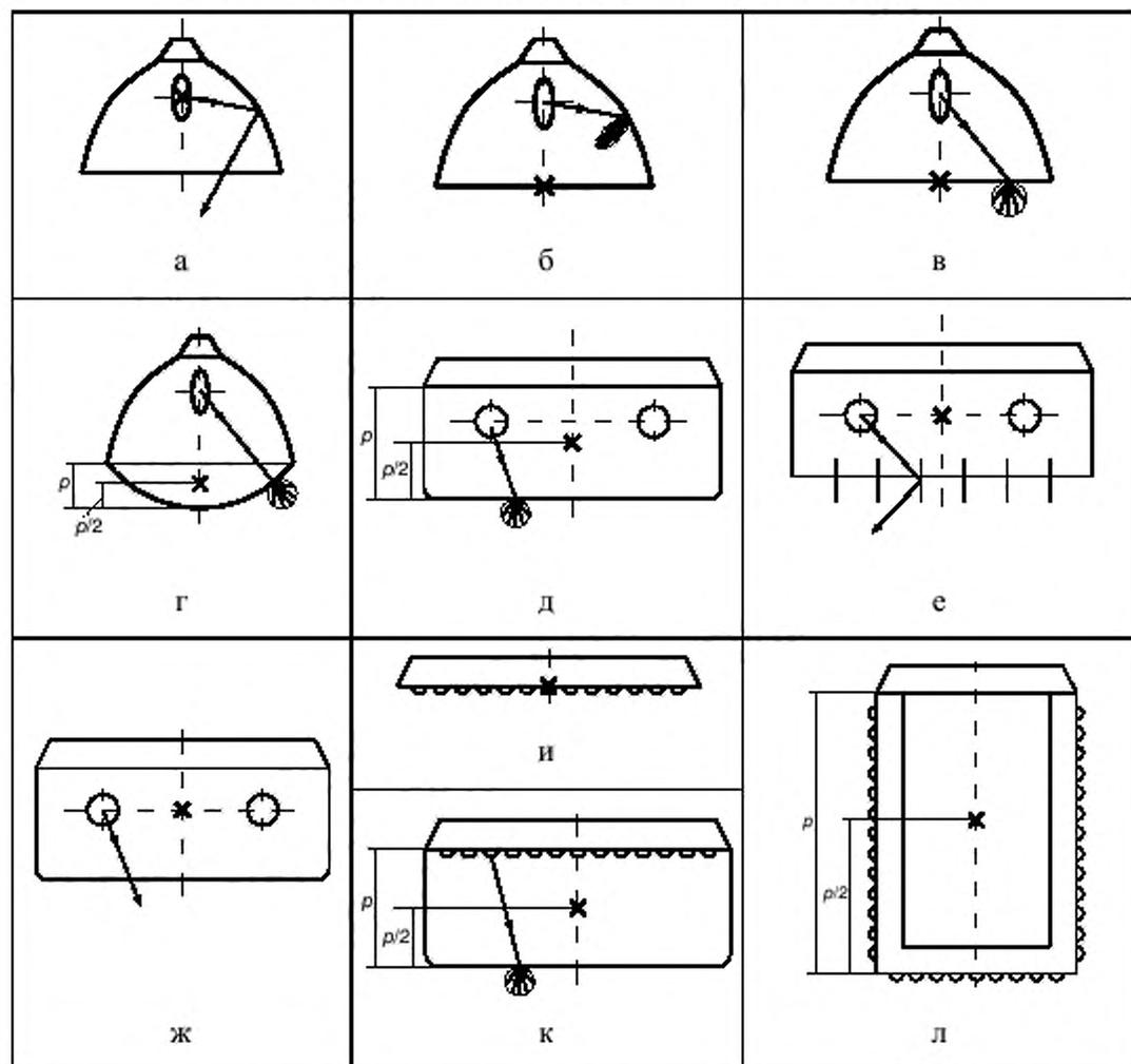
**х** – положение фотометрического центра; а – зеркальный отражатель, выходное отверстие открыто или с прозрачным рассеивателем; б – то же, отражение с рассеянием; в – рассеиватель плоский матированный или призматический; г, д – то же, рассеиватель выпуклый; е – отражатель и решетка зеркальные; ж – рассеиватель прозрачный; и – светодиодный светильник плоский открытый; к – то же, с матированным или призматическим рассеивателем; л – светильник с объемно расположенными светодиодами
