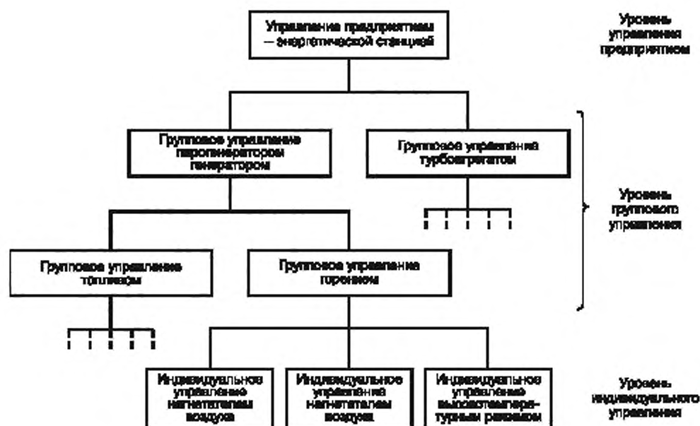
Рисунок А.6 — Уровни управления энергетической станцией (ТЭЦ)
