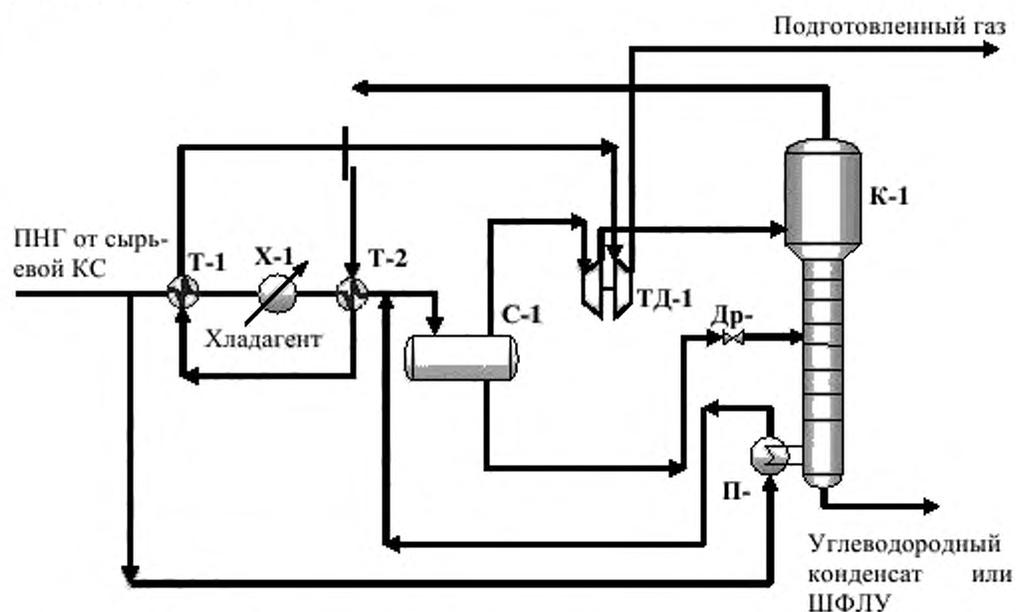
где: Т-1, Т-2 – теплообменники; С-1 – сепаратор; Др-1 – дроссель; ТД-1 – турбодетандер; К-1 – колонна; Х-1 – холодильник; П-1 – подогреватель
