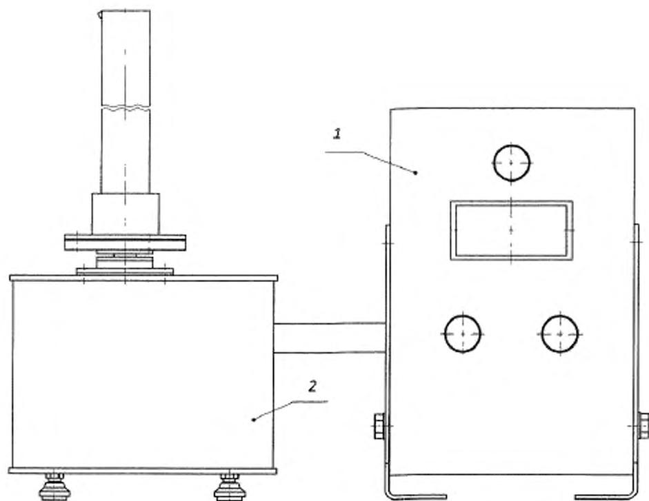
1 – механизм встряхивания; 2 – блок управления, включающий счетчик, оснащенный автоматическим ограничителем
