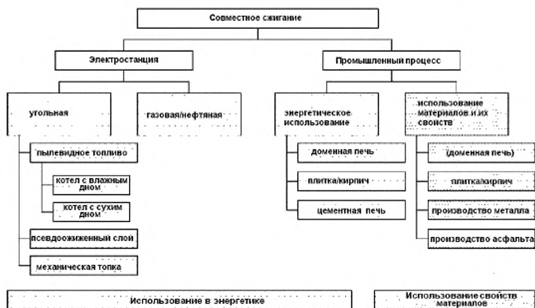
Рисунок 1 — Схема определения характера сгорания твердого топлива из бытовых отходов
