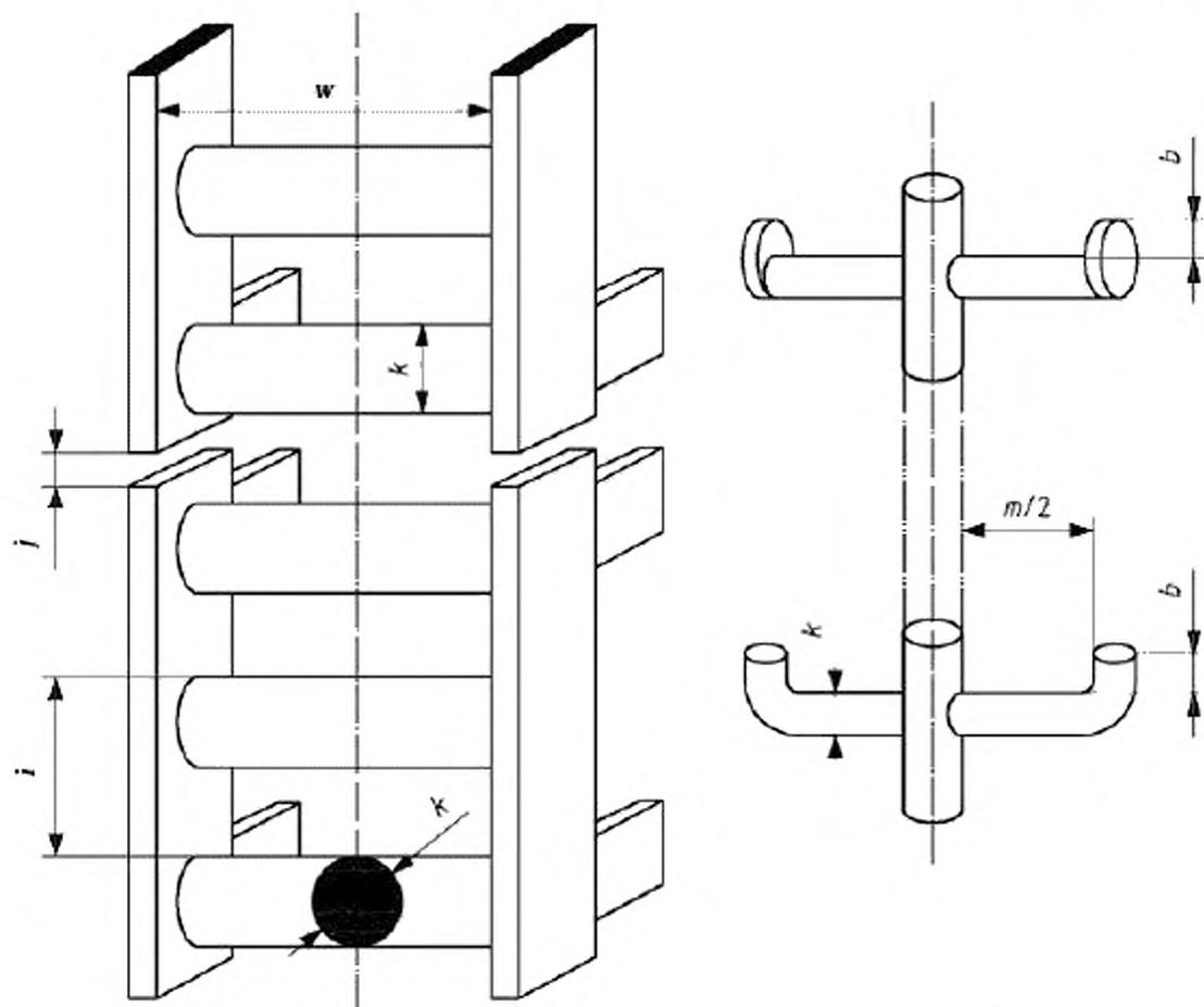
$b$  – размер выступа конца ступени;  $j$  – зазор между отдельными элементами тетивы лестницы;
