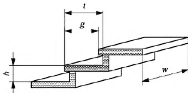
Рисунок 4 – Размерные параметры для лестниц и наклонных лестниц
