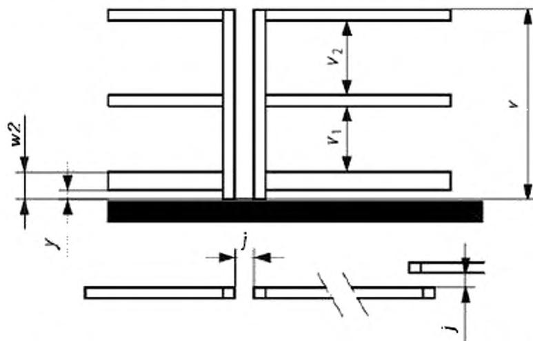
$j$  – величина допустимого разрыва между отдельными секциями перил/поручней;  $v$  – расстояние между настилом/тетивой лестницы и перилами/поручнем;  $v_1$  – зазор между верхом отбортовки и низом ограждения для коленей;  $v_2$  – зазор между верхом и низом поручня перил;  $w/2$  – расстояние между полом и верхней частью отбортовки;  $y$  – зазор между полом и нижним краем отбортовки
