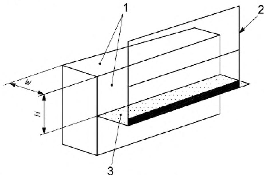
1 – непрерывная поверхность; 2 – перила; 3 – проход; H – высота непрерывной поверхности; W – ширина непрерывной поверхности
