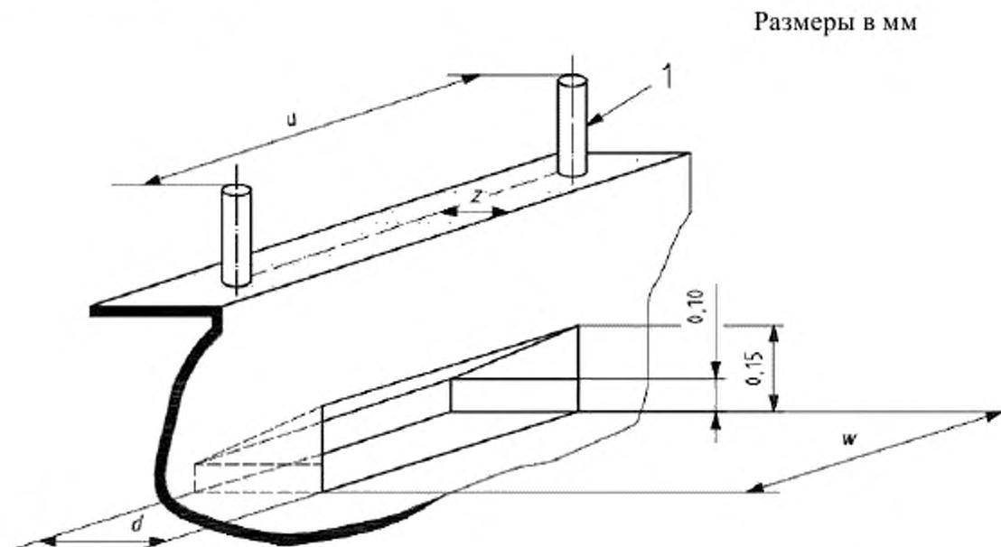
1 – поручень;  $d$  – расстояние между центральной линией ступени и вертикальной поверхностью;  $w$  – ширина ступени;  $u$  – расстояние между параллельными поручнями, между которыми должен быть обеспечен проход;  $z$  – расстояние между ступенью и поручнем/перилами
