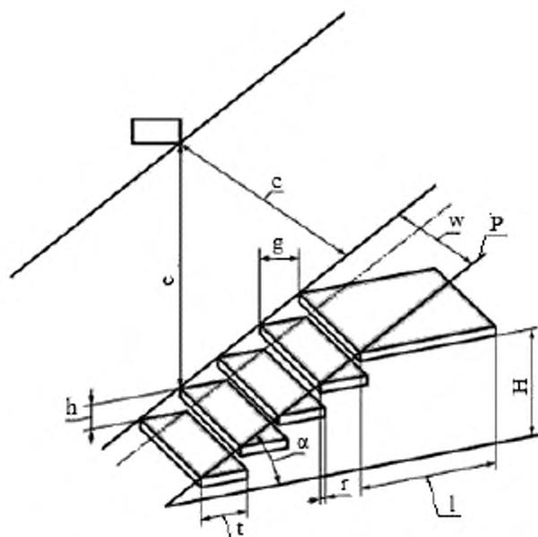
*H* – высота подъема; *g* – проступь; *e* – высота в свету; *l* – длина площадки; *r* – нахлест; *P* – осевая линия;  $\alpha$  – угол наклона лестницы; *h* – высота ступени; *w* – ширина лестницы; *t* – ширина ступени; *c* – просвет
