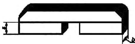
Образец, выполненный нагретым инструментом в раструб
