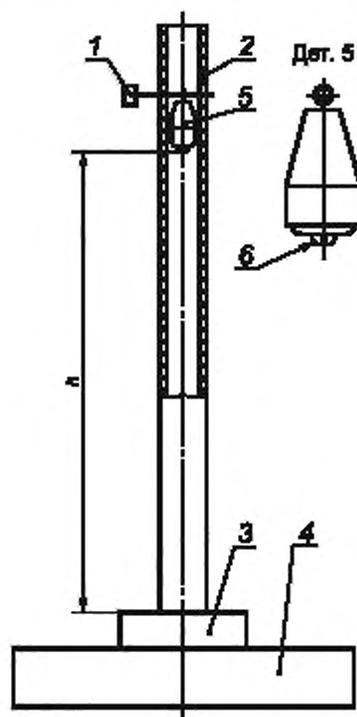
1 — регулировочный штифт; 2 — пластмассовая направляющая труба; 3 — испытуемый образец;
