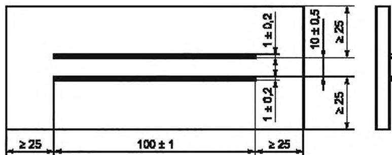
Рисунок 4 — Испытательный образец с электродами из проводящей краски
