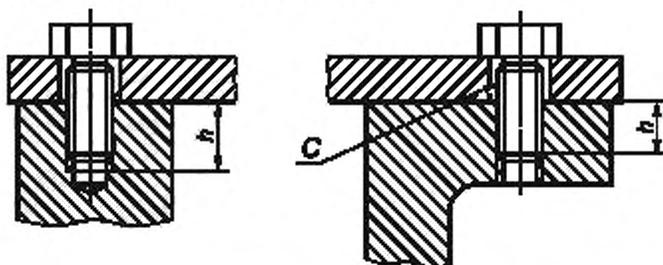
Размер  $h$  должен быть не менее основного диаметра резьбы крепежной детали
