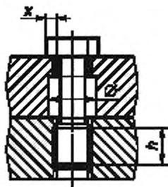
Ø — отверстие со стандартным зазором для прохода резьбы соответствующей формы.
