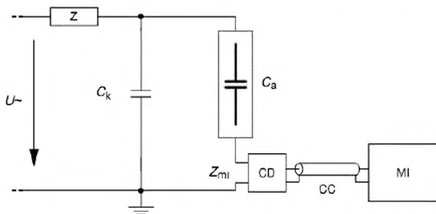
**Компоненты:**  $U\sim$  - источник высокого напряжения;  $Z_{mi}$  - входной импеданс измерительной системы;  $CC$  - соединительный кабель;  $OL$  - оптический канал;  $C_a$  - испытуемый объект;  $C_k$  - конденсатор связи;  $CD$  - измерительный элемент;  $MI$  - измерительный прибор;  $Z$  - фильтр
