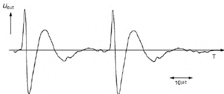
а –  $\Delta f = 45 \dots 440$  кГц, удлинненный сигнал входного импульса
