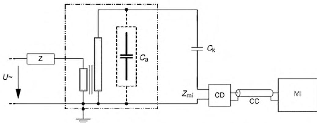
Компоненты:  $U\sim$  - источник низкого или высокого напряжения;  $Z_{mi}$  - входной импеданс измерительной системы,  $CC$  - соединительный кабель,  $C_k$  - конденсатор связи;  $CD$  - измерительный элемент;  $C_a$  - испытуемый объект,  $MI$  - измерительный прибор,  $Z$  - фильтр
