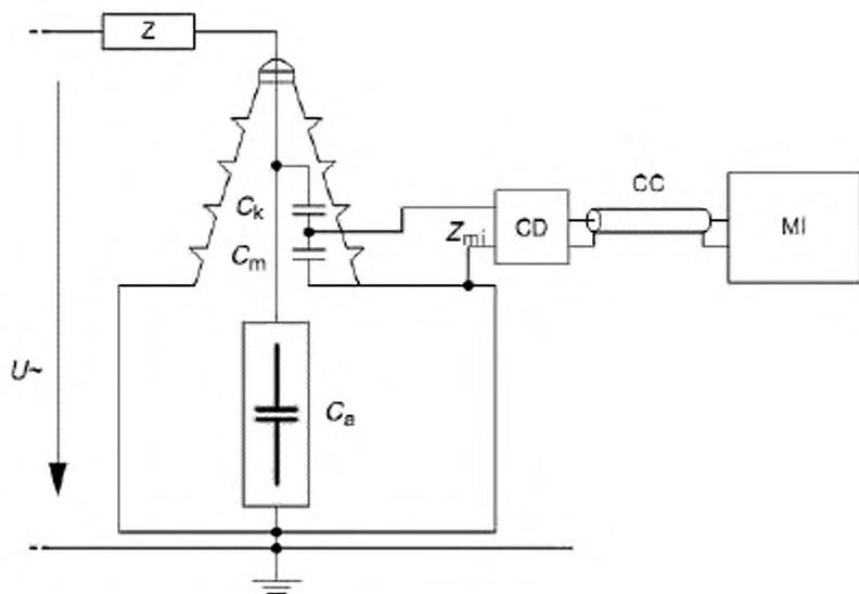
Компоненты:  $U\sim$  - источник низкого или высокого напряжения,  $Z_{mi}$  - входной импеданс измерительной системы;  $CC$  - соединительный кабель;  $C_k$  - конденсатор связи;  $C_m$  - емкость параллельная  $Z_{mi}$ ;  $CD$  - измерительный элемент,  $C_a$  - испытуемый объект,  $MI$  - измерительный прибор;  $Z$  - фильтр
