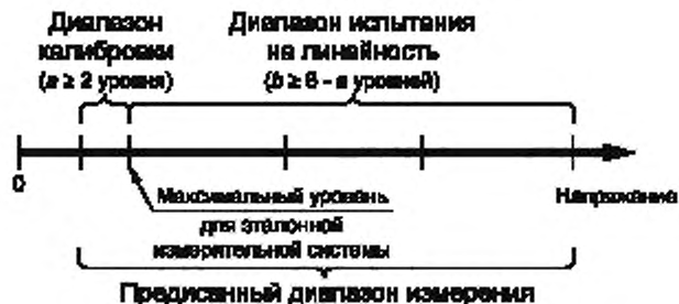
Рисунок 4 — Калибровка методом сличения с дополнительным испытанием на линейность
