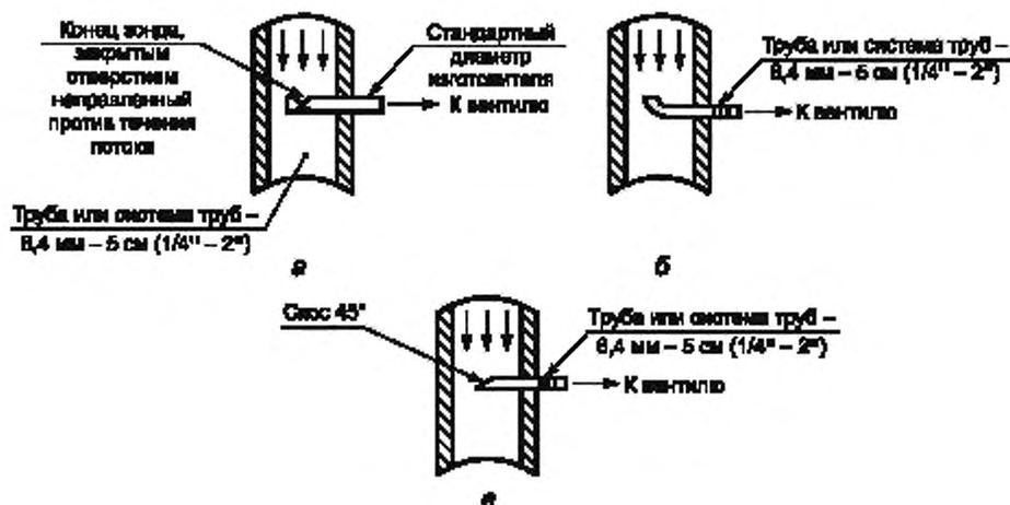
Примечание — Зонды можно снабдить вентилями (клапанами) или кранами с пробкой (заглушкой). Зонд следует располагать горизонтально.
