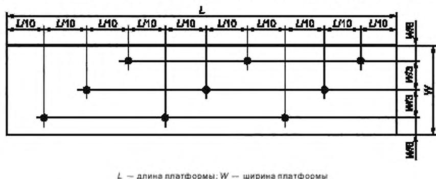
Рисунок 12 — Положение точек отбора проб на открытой поверхности железнодорожной платформы
