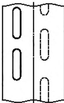
Рисунок 2 — Напорная труба (с перекрывающимися отверстиями)
