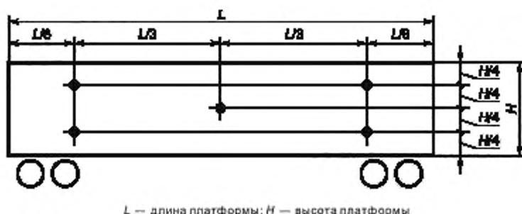
Рисунок 11 — Положение точек отбора проб на различных уровнях железнодорожной платформы
