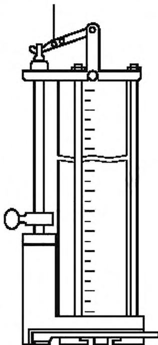
Рисунок 3 — Желонка стержневого типа для отбора проб нефтепродуктов
