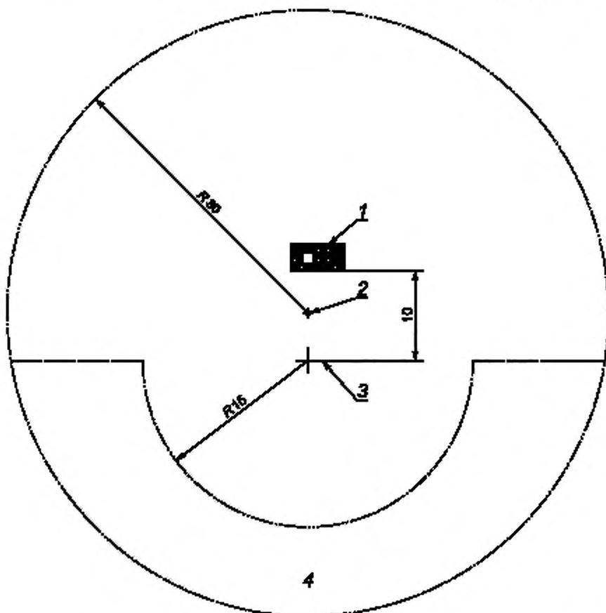
1 — машина; 2 — центр свободной области посередине между антенной и машиной; 3 — антенна; 4 — допустимая зона расположения испытательной станции или передвижного пункта, в котором располагаются измерительные приборы
