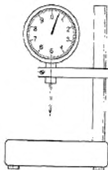
Рисунок 1 – Индикатор с круговой шкалой, фиксированный на стойке
