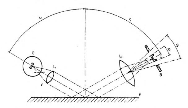
G - источник света; L<sub>1</sub>, L<sub>2</sub> – линзы; B - полевая диафрагма приемного устройства; P - лакокрасочное покрытие;  $\epsilon_1$  - угол падения,  $\epsilon_2$  – угол отражения ( $\epsilon_1$  =  $\epsilon_2$ );  $\sigma_B$  – апертурный угол приемной системы;  $\sigma_S$  – апертурный угол изображения источника света; I – изображение источника света
