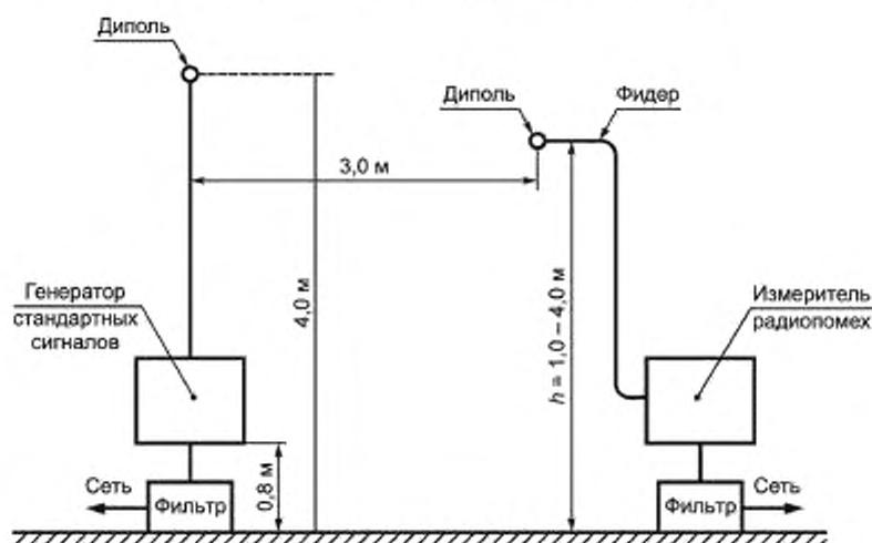
Рисунок 12 — Расположение аппаратуры при аттестации площадки
