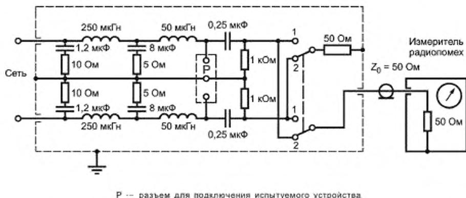
Рисунок 4 — Пример схемы Y-образного эквивалента сети 50 Ом/50 мкГн + 5 Ом
