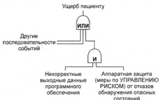
Рисунок 2 — FTA (анализ дерева неисправностей) показывает меру по УПРАВЛЕНИЮ РИСКОМ, которая препятствует неправильным выходным данным программного обеспечения причинить ВРЕД
