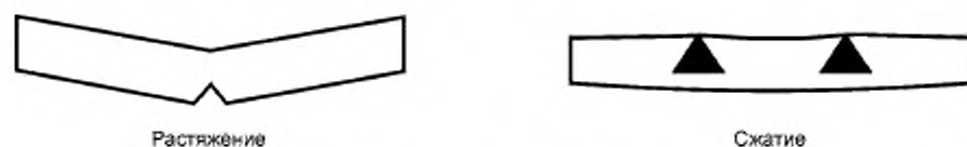
Рисунок Б.6 — Типы разрушения без сдвигов
