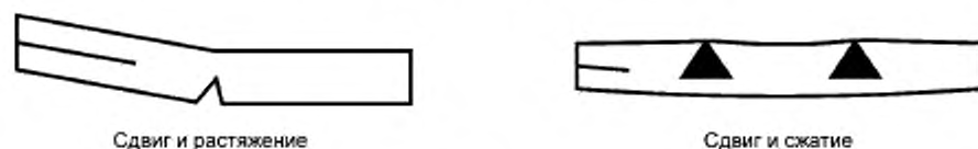
Рисунок Б.5 — Смешанные типы разрушения
