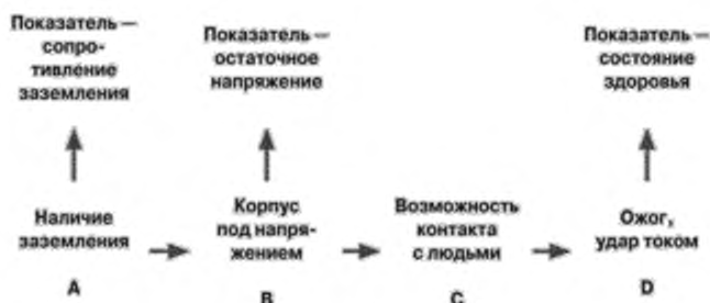
Рис. 2. Пример опасного события «корпус под напряжением»
