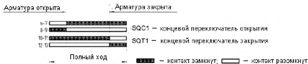
Рисунок У.3 – Электрическая схема соединения электромагнитов управления и концевых переключателей отсечной пневмоприводной быстродействующей арматуры (НО и НЗ) при установке под оболочкой и вне оболочки
