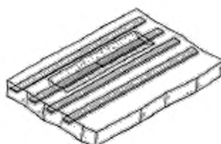
Рисунок 24 б – Удаленный защитный слой
