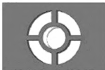
Рисунок 29 а – Металлизированное переходное отверстие, соединенное перемычками с внутренним слоем
