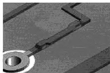
Рисунок 20 ф – Завершенный ремонт
