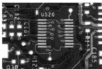
Рисунок 23 а – Нанесенный изоляционный слой
