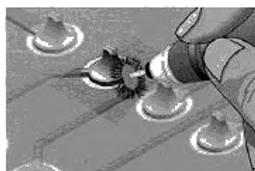
Рисунок 4 с – Мягкое покрытие удаляют вращающимися щетками
