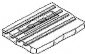
Рисунок 24 г – Припаивание сменного проводника
