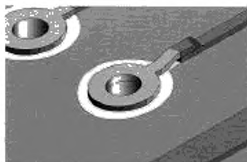
Рисунок 32 д – Завершенный ремонт
