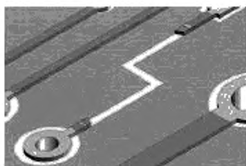
Рисунок 21 а – Удаление покрытия с концов проводников
