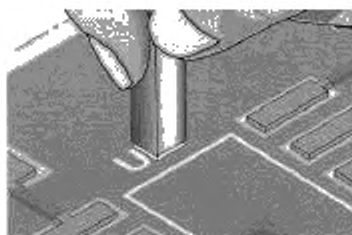
Рисунок 7 а – Нанесение маркировки штампом
