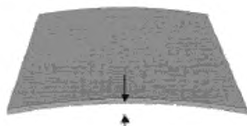
Рисунок 12 а – Проверка прогиба печатной платы
