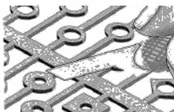
Рисунок 32 б – Вырезание сменной контактной площадки
