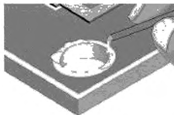
Рисунок 13 б – Введение эпоксидного состава заостренной деревянной палочкой
