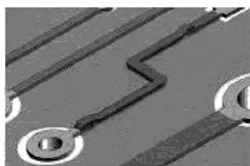
Рисунок 19 ф – Покрытие проводника эпоксидным составом
