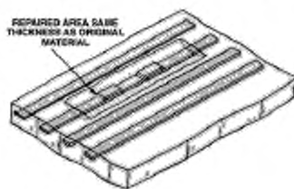
Рисунок 24 х – Герметизация отреставрированного участка
