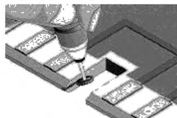
Рисунок 16 б – Фрезерование канавки с обеих сторон выемки ключа
