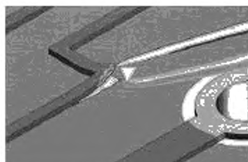
Рисунок 18 а – Внесение кусочка сухой эпоксидной пленки под отслоившийся проводник
