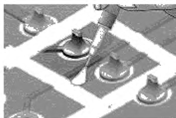
Рисунок 5 б – Удаление покрытия микроструйной системой
