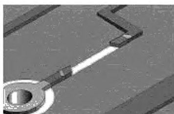
Рисунок 20 а – Удаление с проводников паяльной маски
