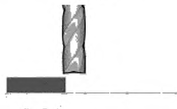
Рисунок 10 б – Выравнивание кромки ручной дрелью или надфилем
