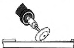
Рисунок 24 с – Удаление шлифовальным инструментом
